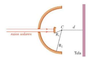
O espelho convexo tem raio de curvatura  $R_1$  igual a 12 cm, e o espelho côncavo tem raio de curvatura  $R_2$  igual a 30 cm.
