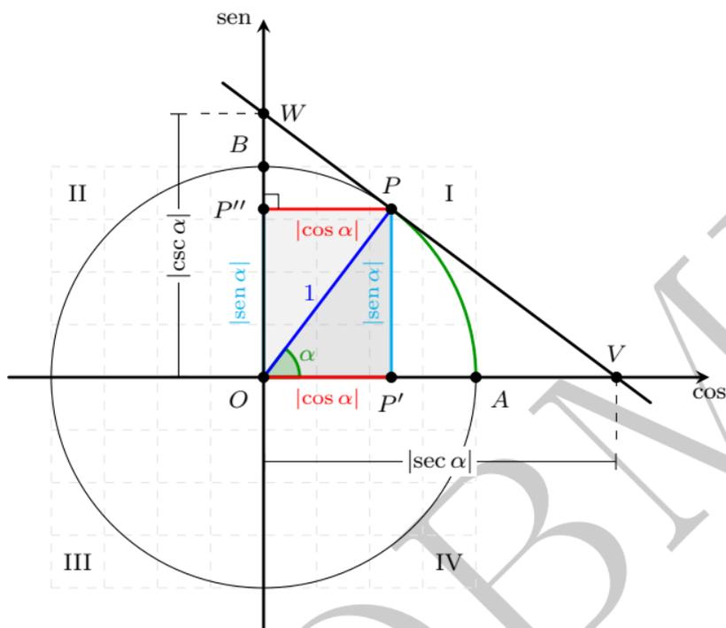
Figura 6: representação da secante e da cossecante.
