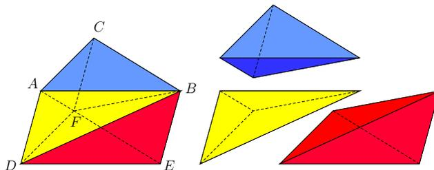
Figura 7: partição de um prisma em três pirâmides.
