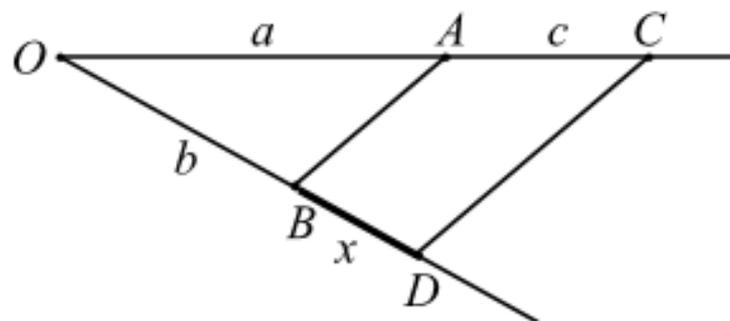
Sobre um ângulo qualquer de vértice  $O$  tomemos sobre um lado os segmentos  $OA = a$  e  $AC = c$  e, sobre o outro lado,  $OB = b$ . Traçando por  $C$  uma paralela à reta  $AB$  determinamos  $D$  na semirreta  $OB$ . O segmento  $BD = x$  é a solução da equação.
