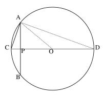
Sendo CD o diâmetro, O o centro da circunferência e P o ponto de interseção de AB com CD temos, no triângulo retângulo ACD, a relação  $AC^2 = CD \cdot CP$ . Observe que  $AC = l_{2n}$  e
